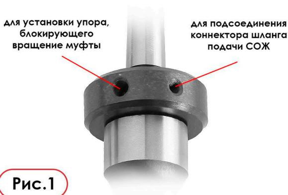
**ВАЖНО!!!** При установке адаптера всегда устанавливать упор, предотвращающий вращение муфты. В противном случае, при вращении адаптера, с коннектора будет срываться шланг подачи СОЖ.
