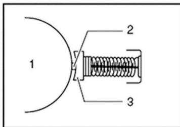
Когда датчик износа, внутри угольной щетки, контактирует с коллектором, он автоматически отключает двигатель. Когда это происходит, следует заменить обе графитовые щетки.
